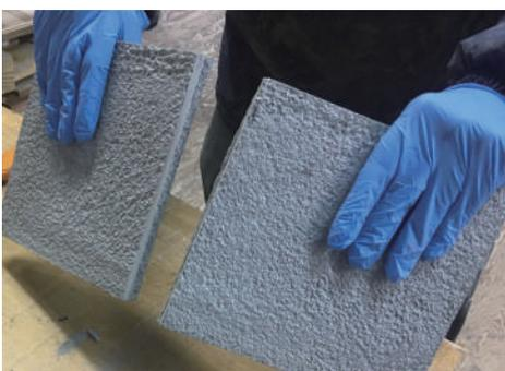
鋸で裏面に筋を入れ割ると切断できます。
